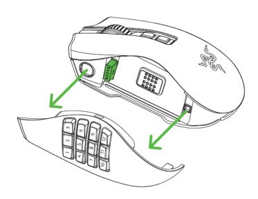
2. Recoloque a placa lateral e insira o dongle USB sem fio na porta USB do PC.
