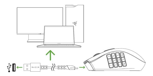
O Razer Naga Pro requer uma conexão USB capaz de fornecer energia suficiente para carregar o dispositivo. O processo de carregamento pode ser afetado ao se conectar o mouse a hubs ou portas USB não energizados, encontrados principalmente em teclados e periféricos. Recomenda-se sempre conectar o Razer Naga Pro diretamente na porta USB do computador.
