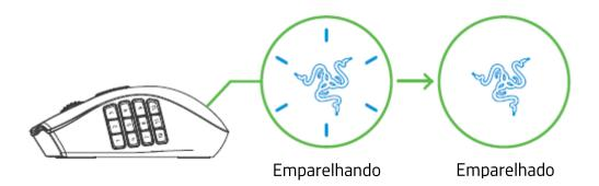
Uma vez emparelhado, o Razer Naga Pro se reconectará automaticamente com seu dispositivo sempre que estiver no modo Bluetooth e se encontrar dentro do alcance. Mantenha os dispositivos em emparelhamento bem próximos um do outro para ter uma conexão mais rápida e estável.
