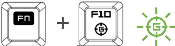
L'activation du mode de jeu vous permet de désactiver la touche Windows afin d'éviter tout appui accidentel. Razer Synapse 2.0 propose en outre la désactivation des combinaisons Alt + Tab et Alt + F4 via l'onglet Mode de jeu. Un voyant s'allume lorsque le mode Jeu est activé.
