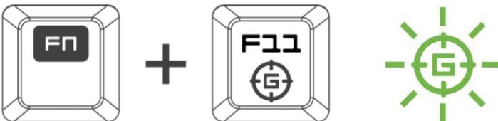
L'activation du mode de jeu vous permet de désactiver la touche Windows afin d'éviter tout appui accidentel. Razer Synapse 2.0 propose en outre la désactivation des combinaisons Alt + Tab et Alt + F4 via l'onglet Mode de jeu. Un voyant s'allume lorsque le mode Jeu est activé.
