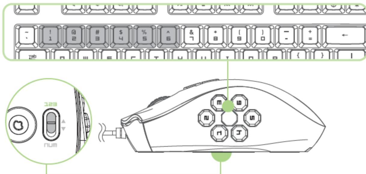
在基本 [123] 模式中，6个机械式拇指按键与键盘数字键的功能相同。这些按键使您可将多数游戏的动作栏复制到拇指键区的按键上。
