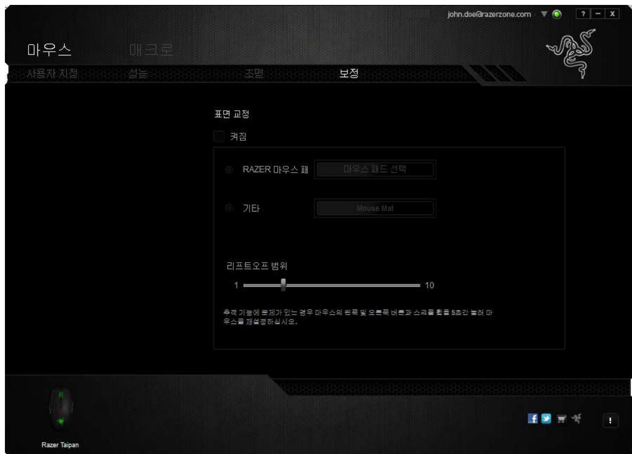
리프트오프 범위를 사용하면 마우스 표면에서 마우스를 들었을 때 센서가 트래킹을 멈추는 거리를 설정할 수 있습니다. 이 기능을 사용하려면 먼저 표면 보정을 활성화한 후 해당 마우스 표면을 선택해야 합니다.
