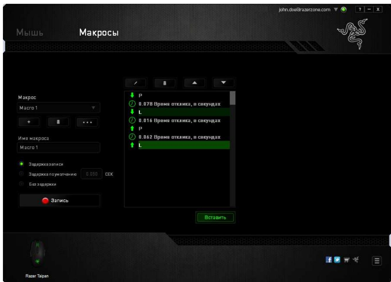
Кнопка позволяет редактировать определенную команду, а кнопка используется для удаления команд. Кнопки и используются для перемещения команд вверх и вниз.
