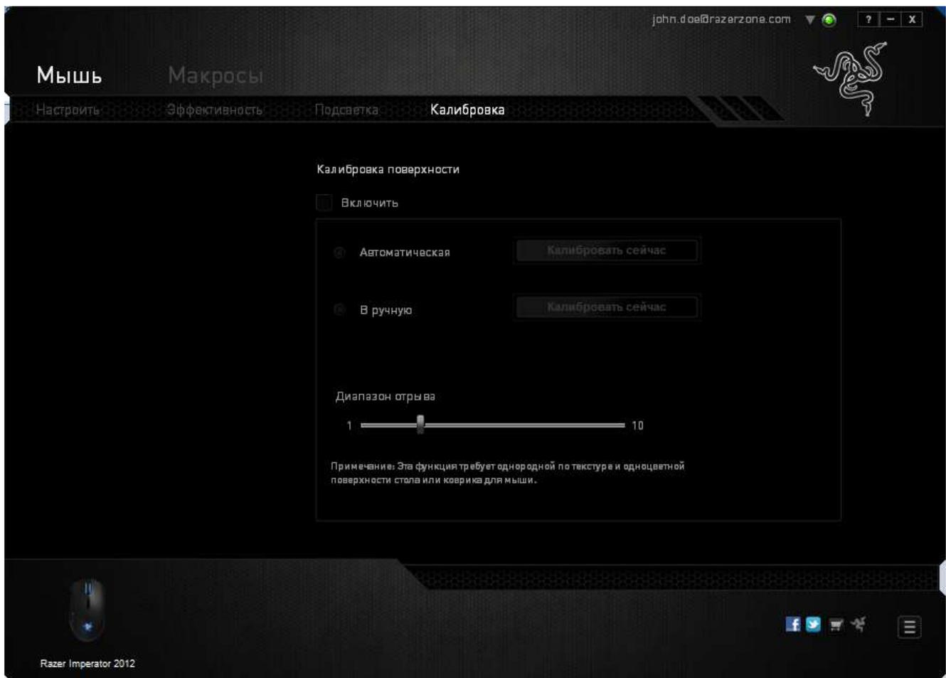
Параметр ДИАПАЗОН ОТРЫВА позволяет задать значение расстояния, при котором датчик перестает функционировать при отрыве мыши от рабочей поверхности.
