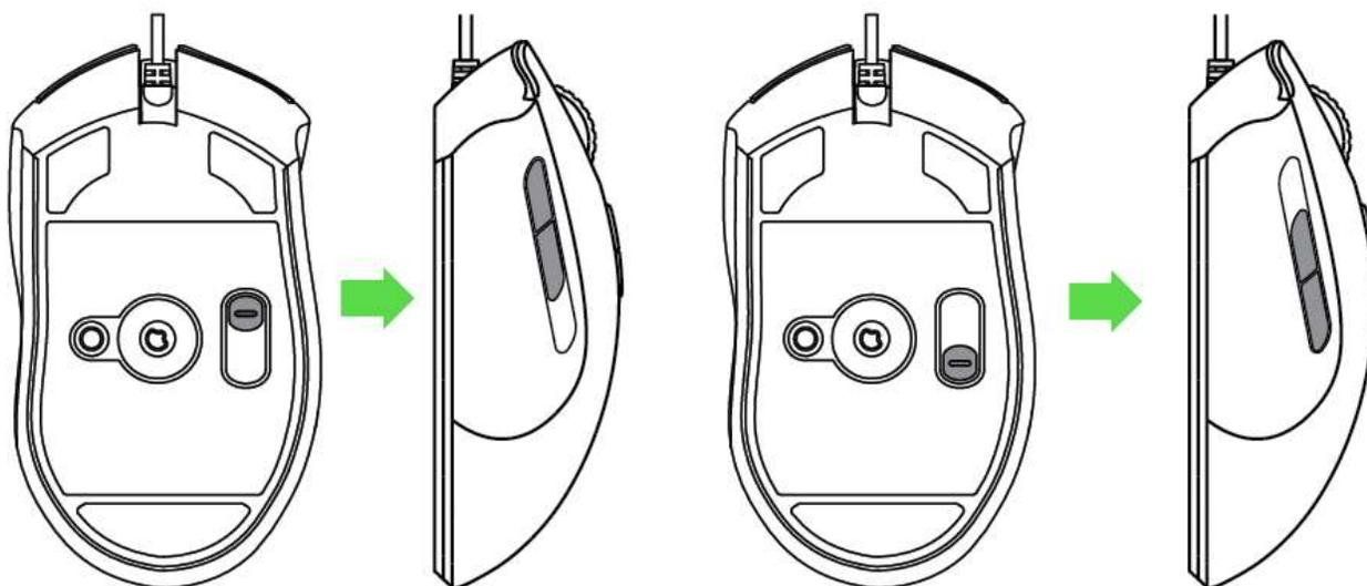
Для максимального удобства использования боковых кнопок в соответствии с различными размерами ладоней и стилями охвата расположение кнопок можно изменять следующим образом:
