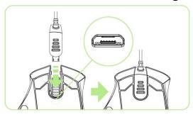
3. Conecta el ratón al puerto USB de tu PC. El Razer Naga Epic estará listo para usarse como ratón con cable de alto rendimiento. Además, la batería comenzará a cargarse automáticamente en el modo con cable.
