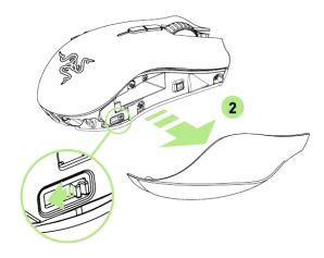
3. Desliza el interruptor de bloqueo e introduce la batería en su compartimiento. (Desliza el interruptor de bloqueo de nuevo para poder extraer la batería).
