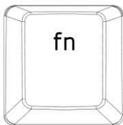
Нажатие клавиши fn в сочетании с функциональными клавишами активирует их второстепенные задачи на вашем ПК.
