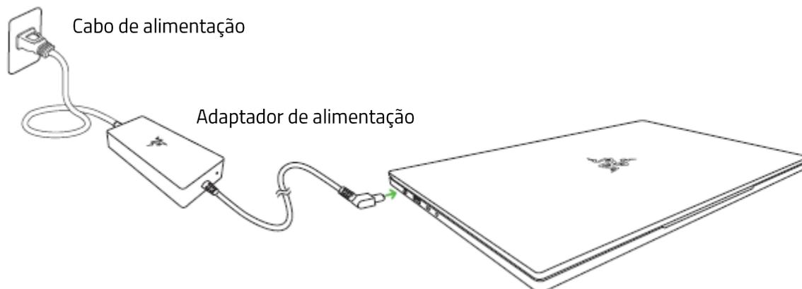
**!** Use o cabo de alimentação adequado para a sua região. Para o primeiro uso, carregue totalmente o seu laptop primeiro ou conecte-o à tomada antes de ligá-lo. São necessárias pelo menos 2 horas para carregar totalmente o seu Razer Blade 15.
