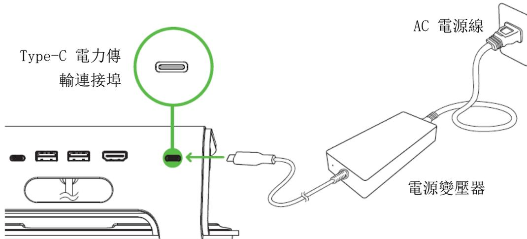
2. 將筆電架連接到筆電的 USB Type-C 電源插孔。
