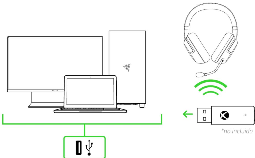
2. Mientras estén apagados, mantén pulsado el botón de encendido hasta que el indicador de estado se encienda o hasta que oigas una señal.
