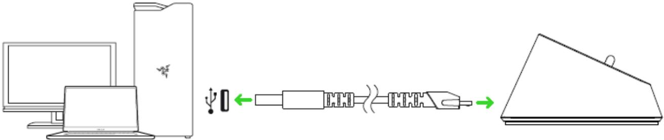
2. Inserta el dongle USB inalámbrico en la base de carga.
