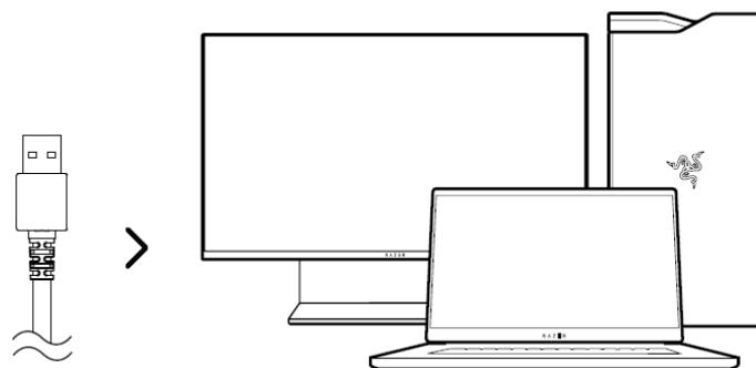
**i** Несмотря на то что подставка для гарнитуры поддерживает порты USB 2.0, рекомендуется подключить ее к порту USB 3.1 для обеспечения высокой производительности и надлежащего питания всех подключенных устройств.
