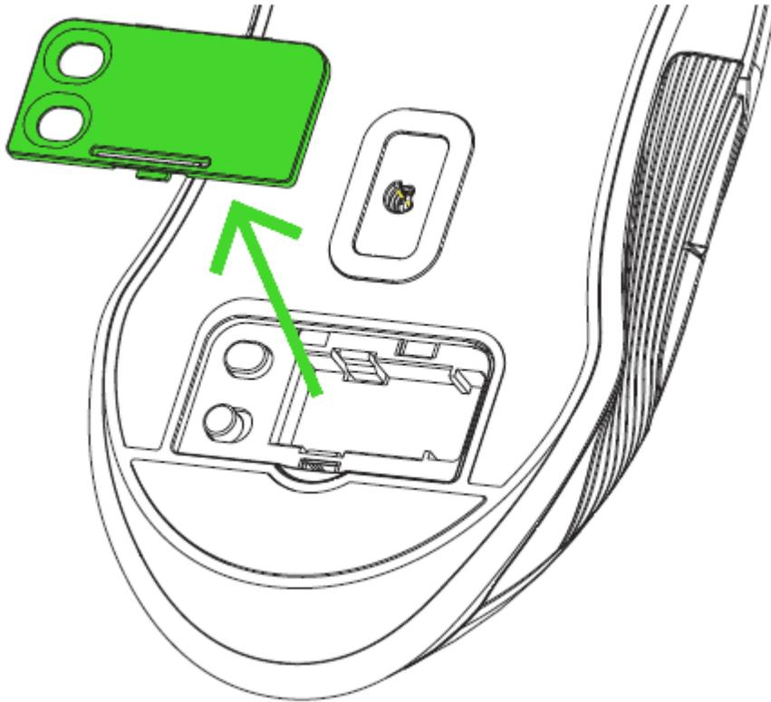
2. Remova o receptor USB sem fio do seu computador e coloque-o no espaço de armazenagem.
