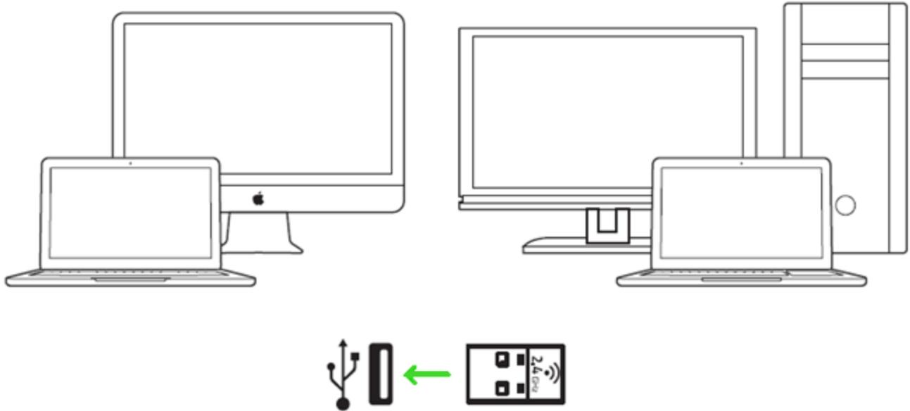
Passo 1: Verifique se o receptor USB sem fio está conectado à porta USB do seu computador.
