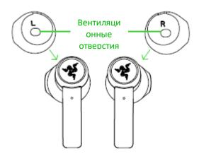
Чтобы использовать насадку, просто вставьте наушник в соответствующую насадку и убедитесь, что вентиляционное отверстие наушника правильно совмещено с отверстием насадки.
