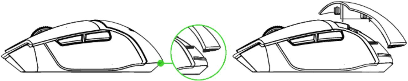
2. Inserta la pila AA incluida en el Razer Basilisk X HyperSpeed siguiendo las instrucciones del compartimiento de las pilas.
