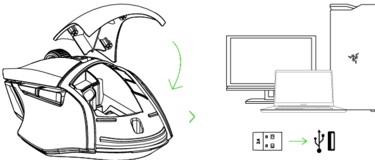
3. Cambia el deslizador al modo 2,4 GHz. El indicador de estado empezará a parpadear rápidamente.
