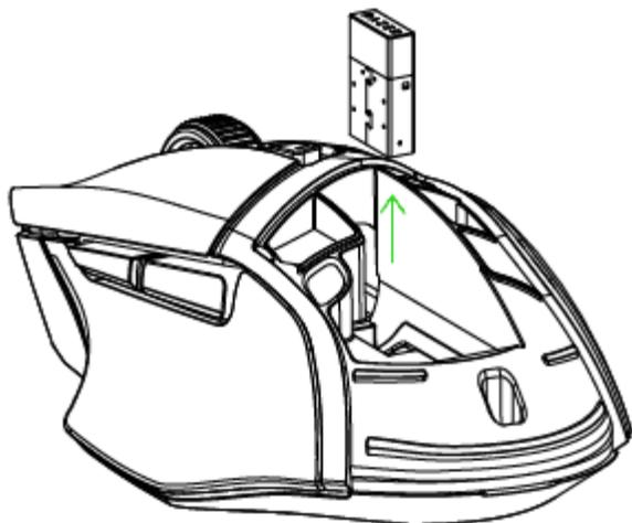
2. Cierra la cubierta superior y conecta el adaptador dongle USB inalámbrico al puerto USB del ordenador.
