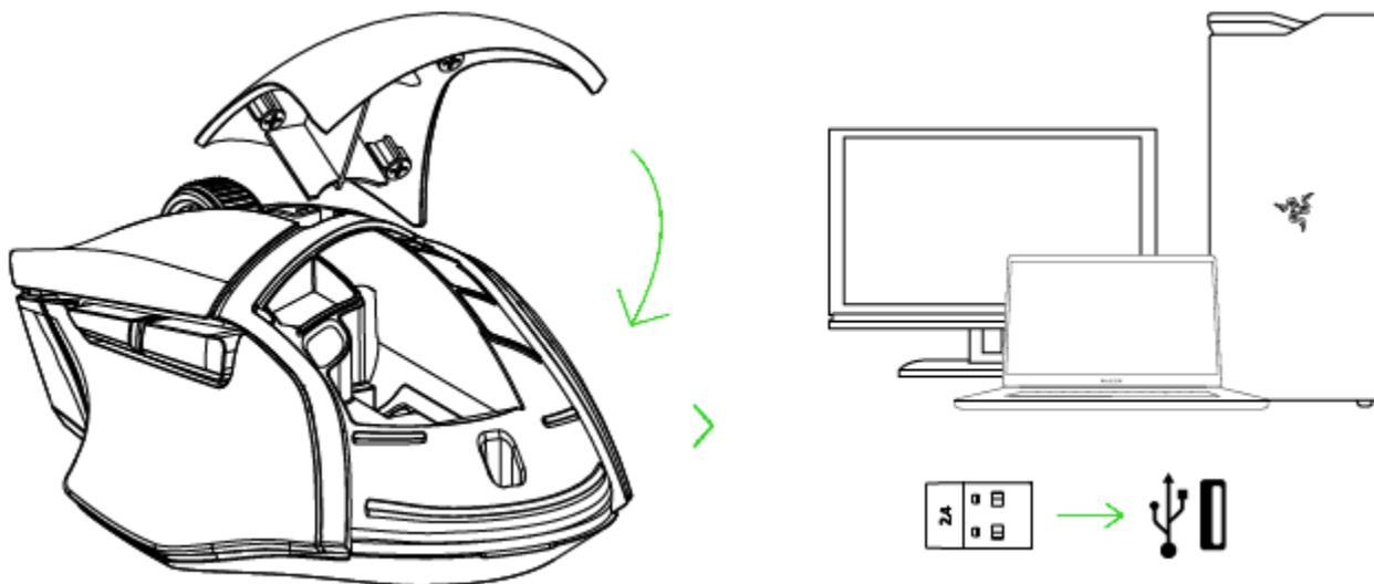
3. 将滑块切换至 2.4 GHz 模式。状态指示灯将开始快速闪烁。
