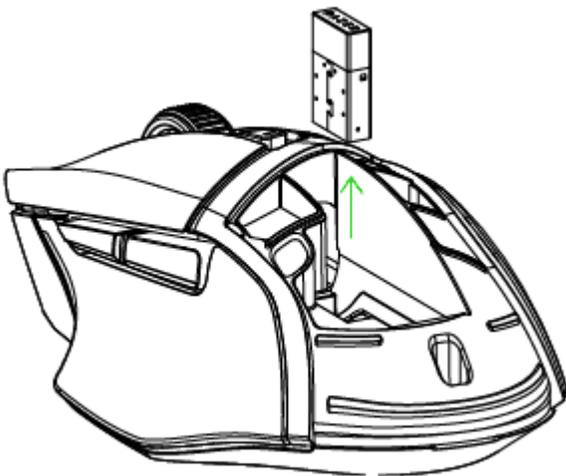
2. 盖上顶盖并将无线 USB 接收器连接至电脑的 USB 端口。
