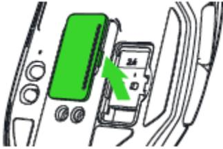
2. Remova o dongle USB sem fio do mouse.
