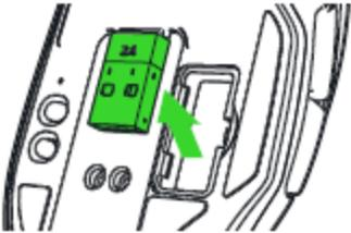
3. Recoloque a tampa do compartimento no Razer Basilisk Ultimate e assegure-se de que ela está firmemente encaixada.
