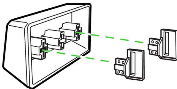
若要將 Razer PBT 鍵帽裝入穩定桿，請將穩定桿的一端插入穩定器，接著使用一字型螺絲起子勾住穩定桿的另一端，將穩定桿輕輕推入穩定器。
