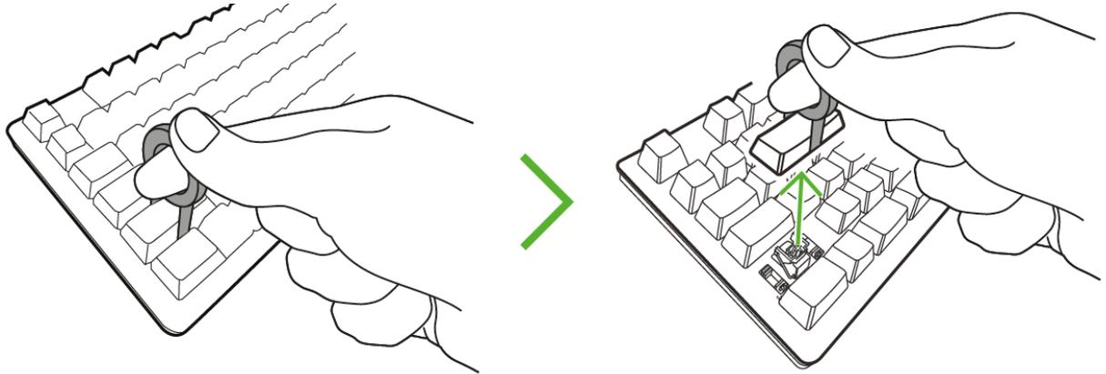
鍵盤上的按鍵如果比較大，輕輕地將要拆下的鍵帽往上提，接著使用一字型螺絲起子（未隨附），將連接穩定桿的任一彎曲端輕輕地往外推，即可鬆開鍵帽。
