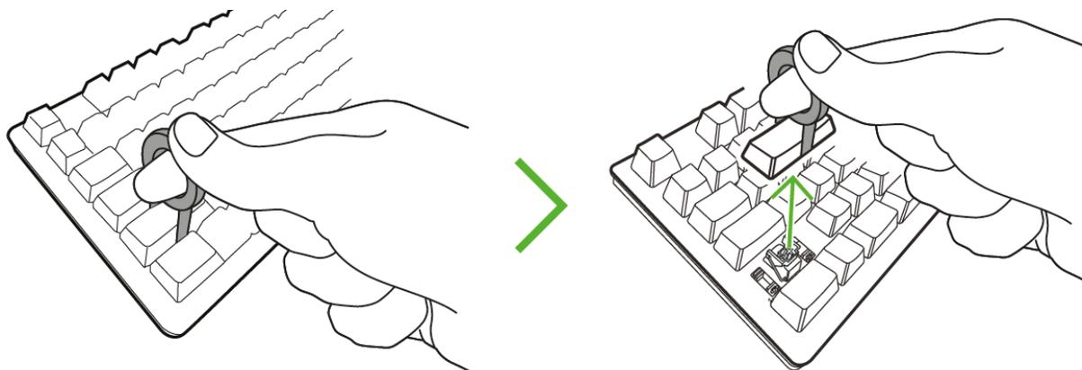
（对于较大的按键）轻轻提起拆下的键帽，并用平头螺丝刀（未随附）将连接的稳定杆的任何弯曲端向外轻推，以松开键帽。
