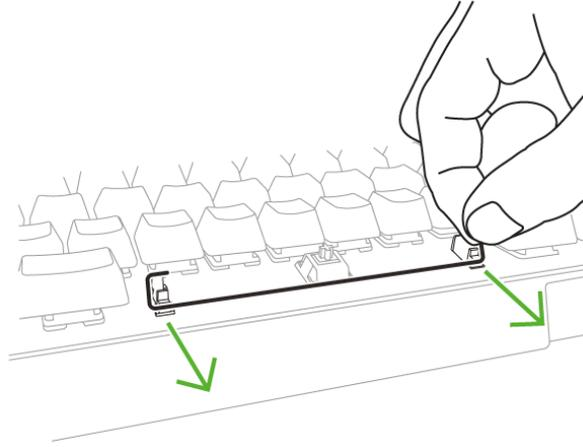
2. （对于较大的按键）在相应的 Razer 雷蛇 PBT 键帽上，将所需的机械键盘稳定器插入对应的轴杆中。
