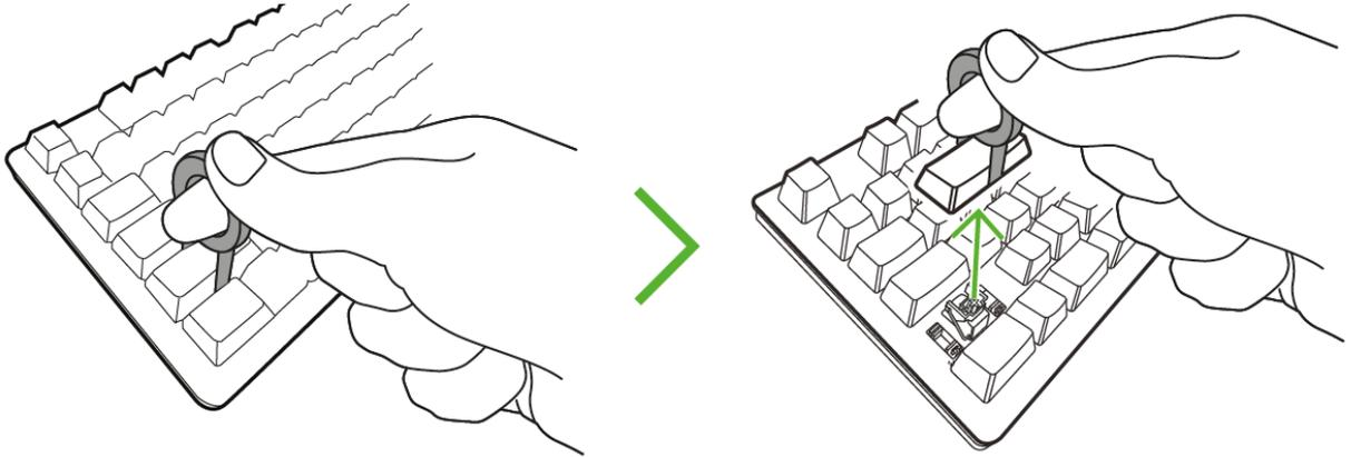
2. (对于较大的按键) 在相应的 Razer 雷蛇 PBT 键帽上, 将所需的光学键盘稳定器插入对应的轴杆中。
