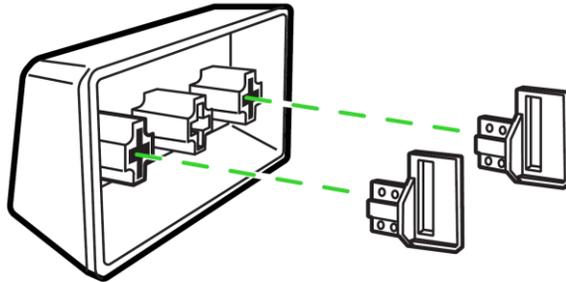
要将 Razer 雷蛇 PBT 键帽安装到稳定杆中，请将稳定杆的一端插入稳定器，然后用平头螺丝刀轻推另一端，使其钩住稳定器。
