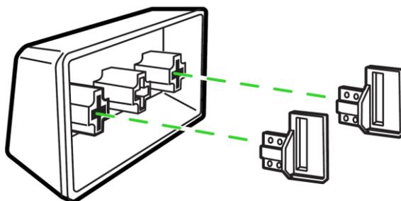
Чтобы установить клавишный колпачок из ПБТ Razer на рычаг стабилизатора, вставьте один конец рычага в стабилизатор и с помощью плоской отвертки заведите другой конец рычага в другой стабилизатор.
