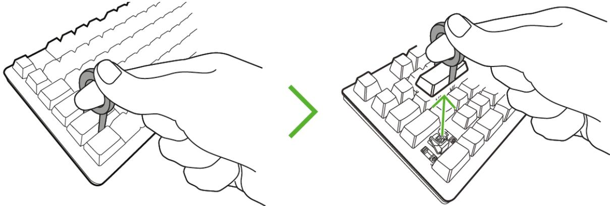
Для более крупных клавиш: чтобы снять клавишный колпачок, аккуратно поднимите отсоединенный клавишный колпачок и поверните прикрепленный рычаг стабилизатора наружу за изогнутый конец с помощью плоской отвертки (не входит в комплект).
