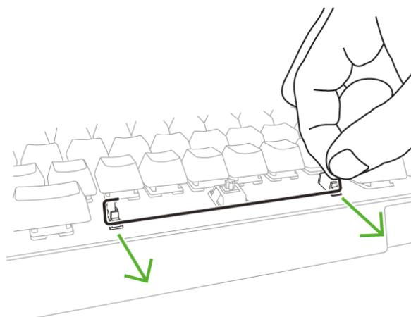
2. (Pour les touches plus larges) Sur la touche en PBT Razer correspondante, insérez le stabilisateur de clavier mécanique requis sur ses tiges.
