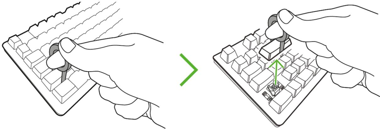
(Pour les touches plus larges) Soulevez doucement la touche détachée et appuyez sur les extrémités courbées de la barre attachée de stabilisateur au moyen d'un tournevis à tête plate (non inclus) pour libérer la touche.
