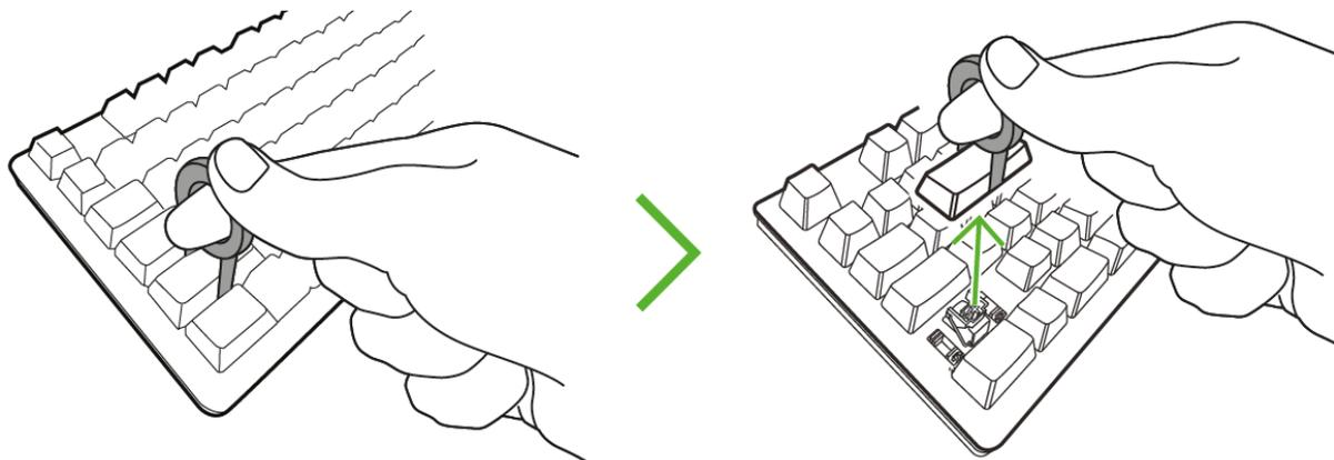
2. (Pour les touches plus larges) Sur la touche en PBT Razer correspondante, insérez le stabilisateur de clavier optique requis sur ses tiges.
