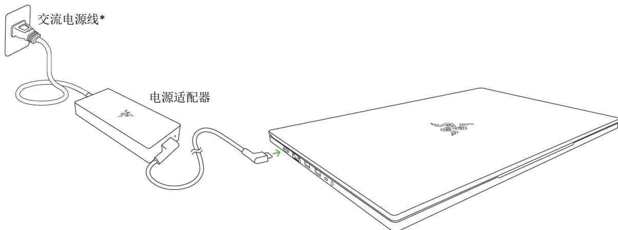
**!** 请使用适用于你所在区域的电源线。如果是第一次使用，请为笔记本电脑充满电，或确保将电脑连接至电源插座再开机。将 Razer Blade Pro 雷蛇灵刃专业版 17 充满电大约需要 2 小时。
