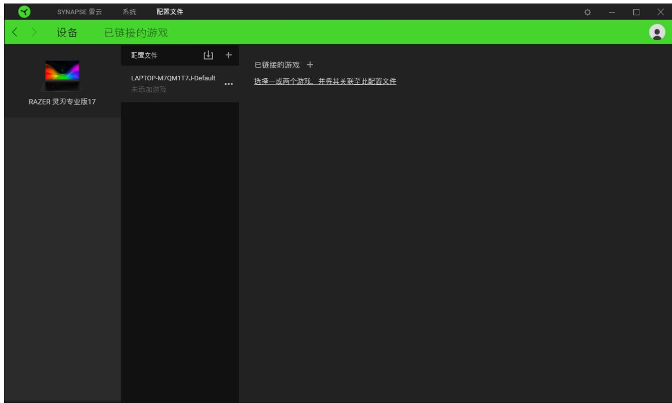
你可以使用导入按钮 (↓) 从你的电脑或从云端导入配置文件 /，或使用添加按钮 (+) 在选择的设备中创建新的配置文件或为特定游戏创建新的。关联后，你可以通过单击相应的设备的“其他”按钮 (•••) 来选择特定的。在使用“链接游戏”选项运行应用程序时，可以将每个配置文件/Chroma 幻彩效果设置为自动激活。
