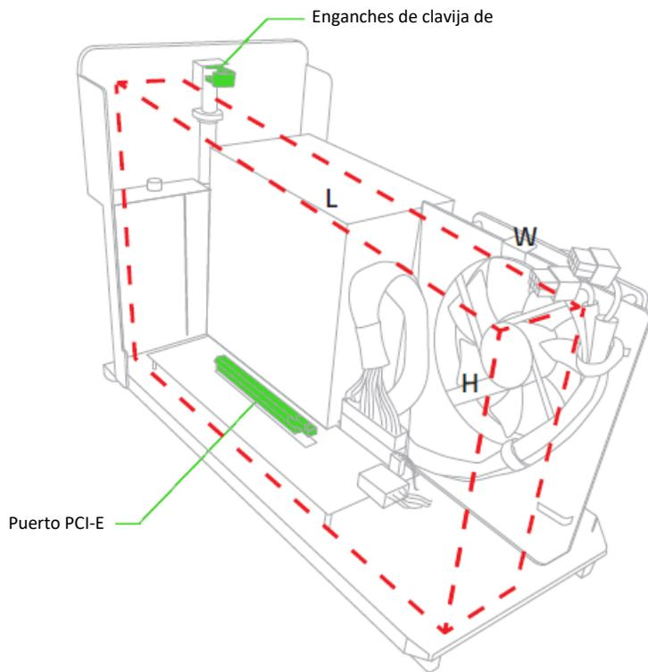
*\*Valor de alto medido desde la parte superior del puerto PCI-E a la parte inferior de los enganches de la clavija de seguridad.*
