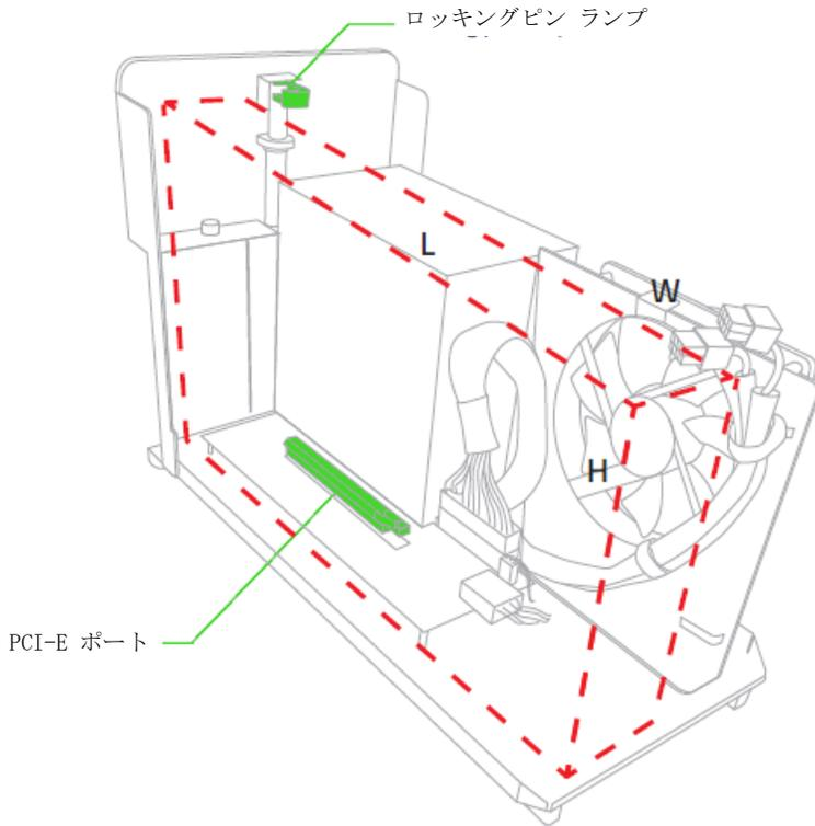
\*高さは PCIe ポート最上部からロッキングピン ランプの最下部までを計測。
