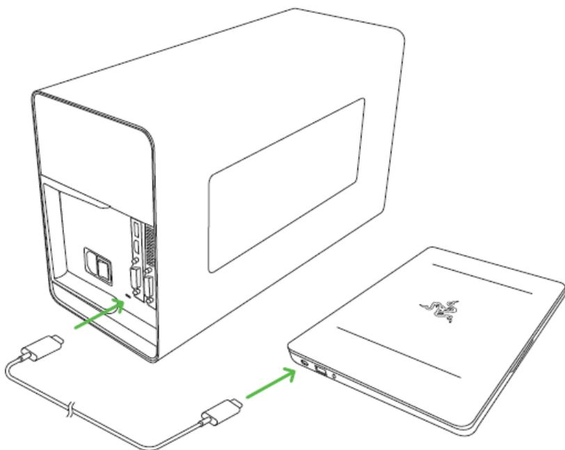
注: この接続によって電力が供給され、対応する USB-C 電力供給タイプのノート PC も充電されます。
