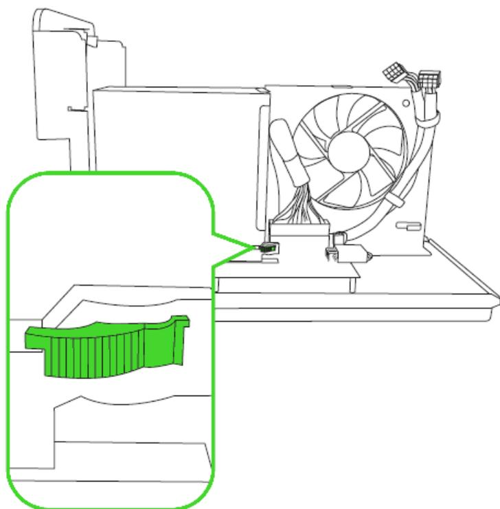
6. PCI-E のツマミねじを再度差し込みます。
