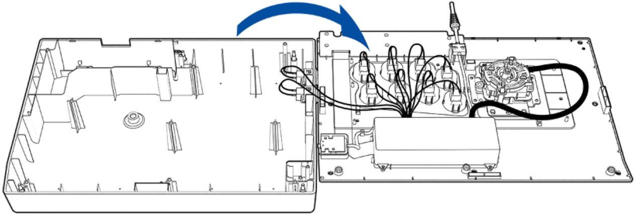
4. Segure com cuidado cada uma das pequenas abas nos cabos Quick Disconnect (QD) para removê-los facilmente do botão de ação.
