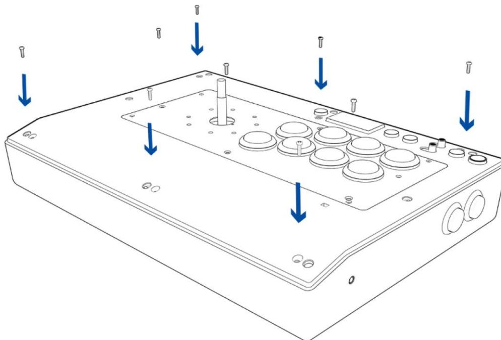
10. Coloque a arte e a tampa da placa no joystick, aperte o parafuso para segurá-lo no lugar e, em seguida, recoloca a tampa do eixo e a proteção contra poeira do joystick.
