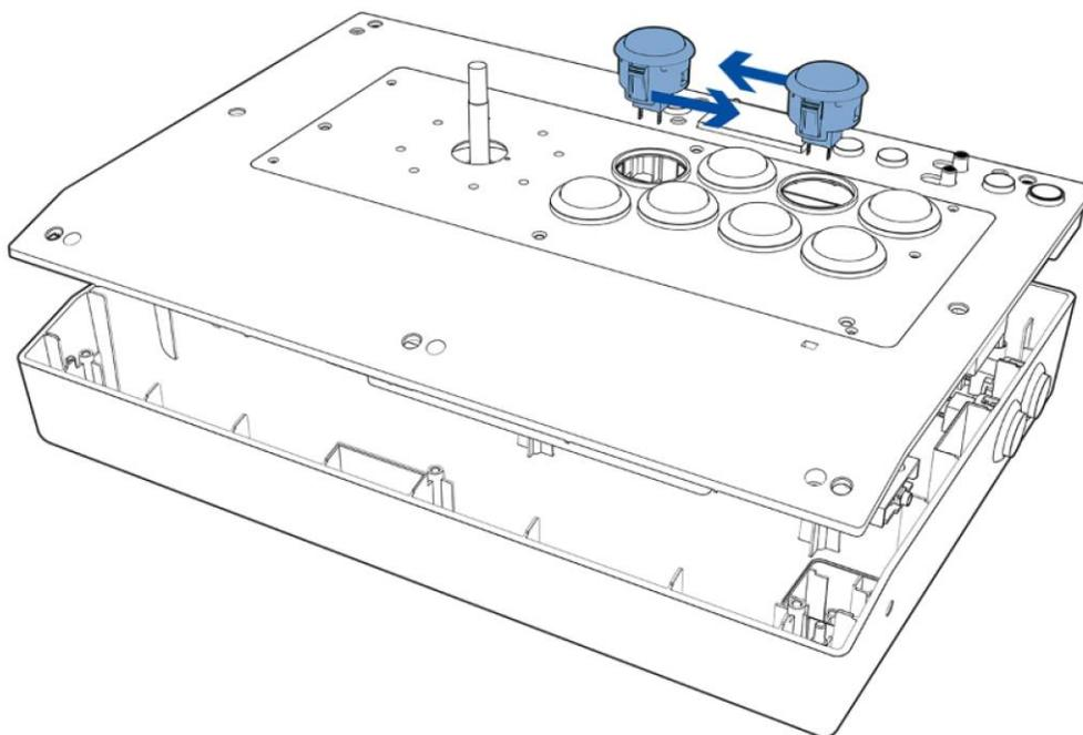
8. Bringe die Kabel wieder an den Action-Tasten an und achte darauf, dass alle Kabel wieder richtig verbunden sind.
