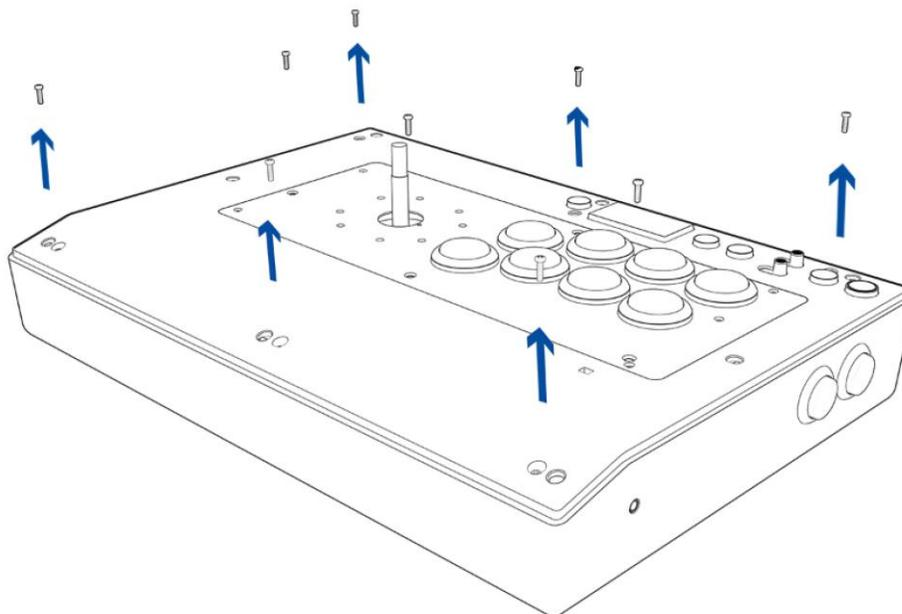
3. Hebe die Abdeckung nach rechts ab und stütze sie mit deiner anderen Hand leicht ab. Nun kommst du an die Action-Tasten und Kabel und Kabel heran.
