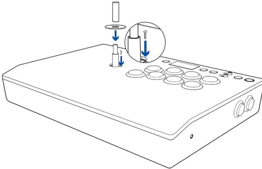
8. Drücke mit einem Schlitzschraubenzieher fest gegen die Schraube im Zugangsloch und schraube den Kugelknopf im Uhrzeigersinn fest.
