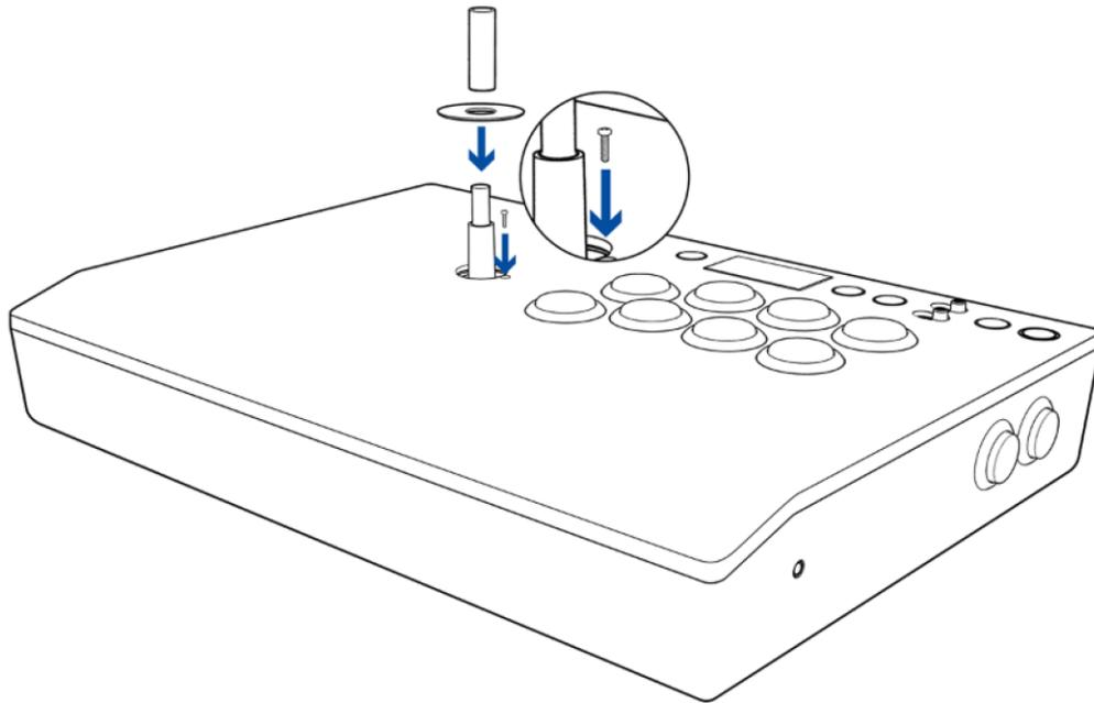
11. Drücke mit einem Schlitzschraubenzieher fest gegen die Schraube im Zugangsloch und schraube den Kugelknopf im Uhrzeigersinn fest.
