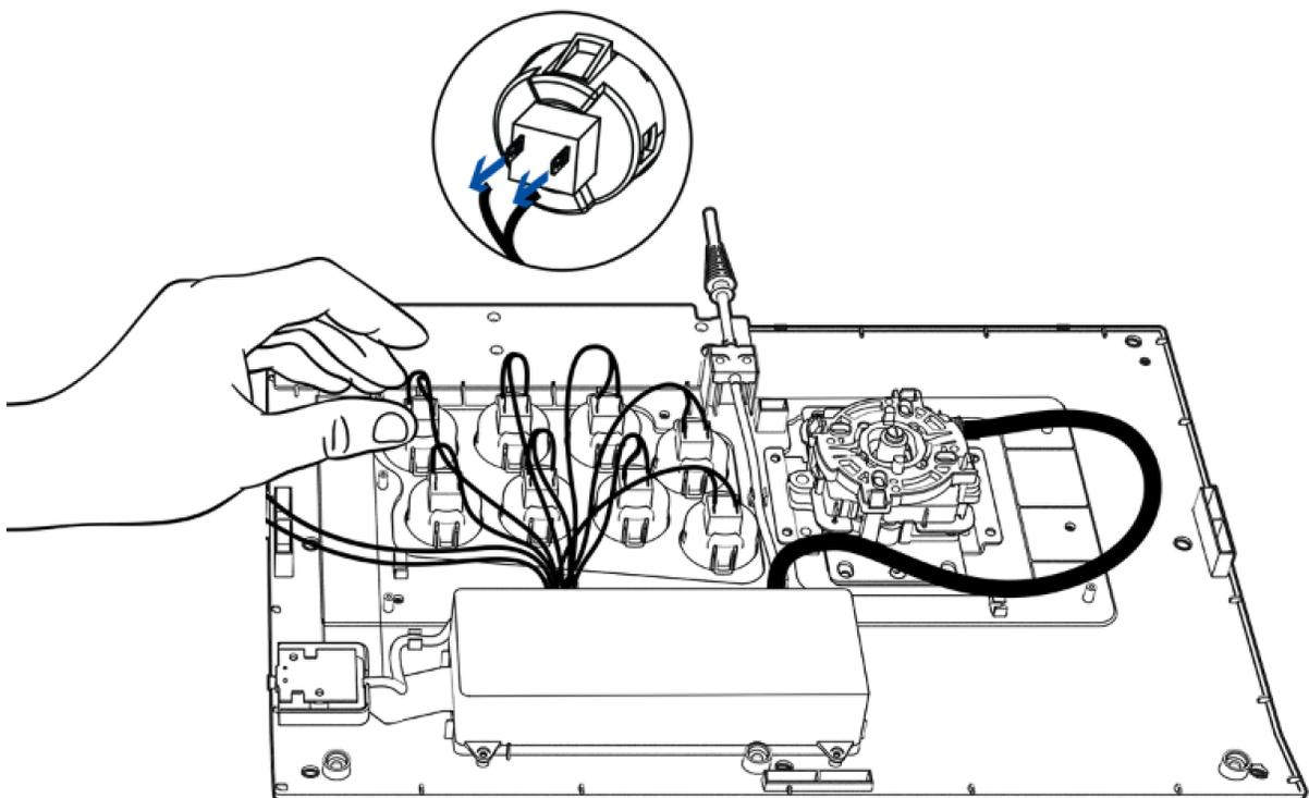
5. Halte die Halterung einer Action-Taste fest und drücke sie dann sanft heraus. Du kannst Halterung auch mit einem Schraubenzieher hineindrücken, wenn du möchtest.
