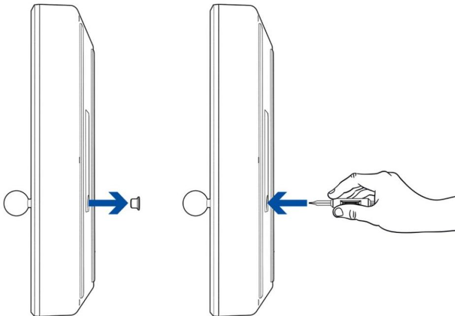
3. Halte den Schlitzschraubenzieher in dieser Position und schraube nun den Kugelknopf entgegen dem Uhrzeigersinn von Joystick-Schaft ab. Nun entferne die Schaftabdeckung und den Staubschutz des Joysticks.
