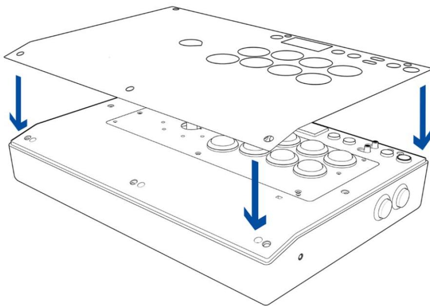
7. Placez la plaque de recouvrement sur le stick arcade, serrez la vis pour le fixer et retournez la gaine de la tige et la protection anti-poussière du joystick.
