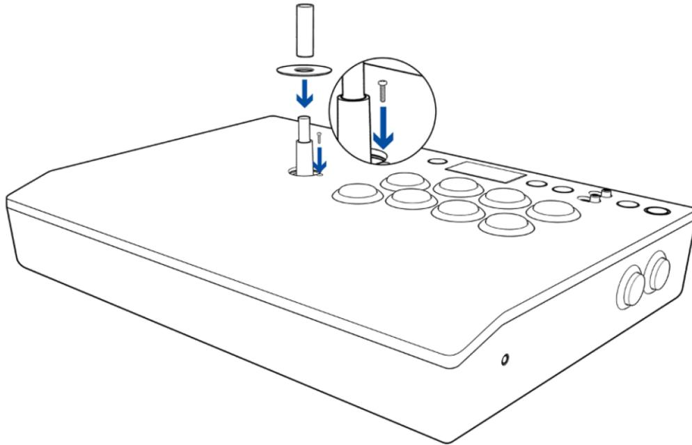
8. Tout en maintenant fermement le tournevis plat dans la vis à l'intérieur du trou d'accès, faites tourner la partie supérieure sphérique dans le sens des aiguilles d'une montre pour la fixer.
