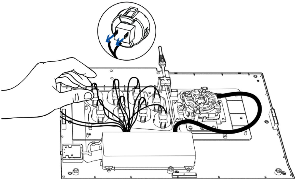
5. Tout en tenant la fixation du bouton d'action, retirez doucement le bouton d'action. Si besoin, vous pouvez utiliser un tournevis pour pousser plus facilement les fixations.
