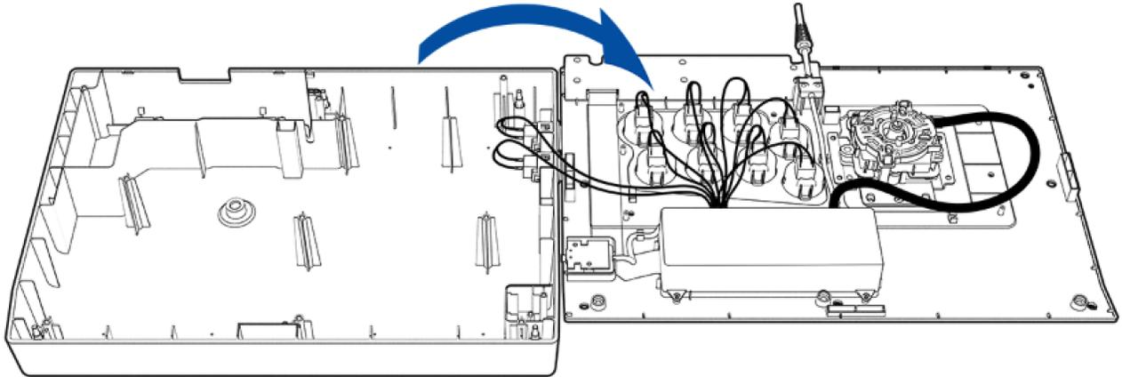
4. Pincez soigneusement chacune des petites languettes des câbles de déconnexion rapide pour les retirer facilement du bouton d'action.
