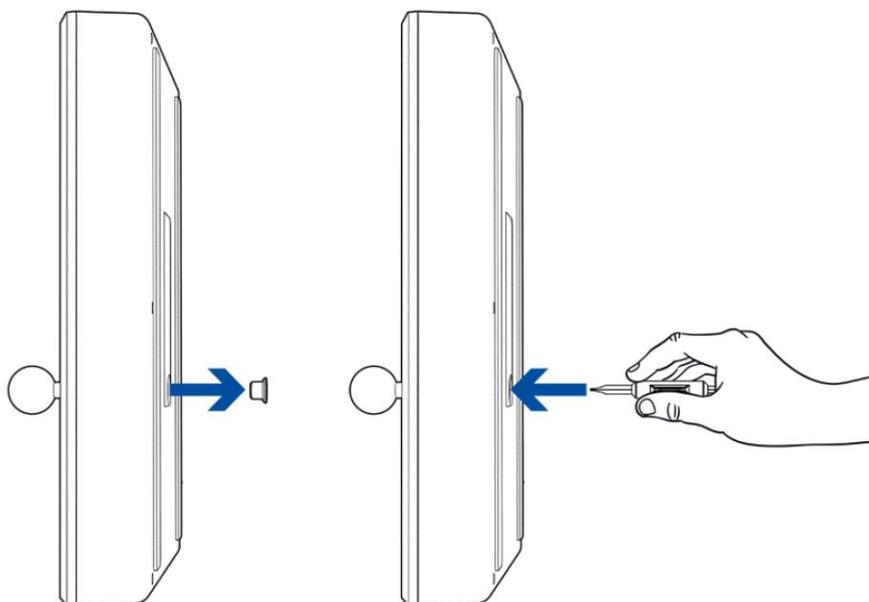
3. Tout en tenant le tournevis plat, faites tourner la partie supérieure sphérique dans le sens inverse des aiguilles d'une montre pour la retirer complètement de la tige du joystick. Ensuite, retirez la gaine de la tige et la protection anti-poussière du joystick.
