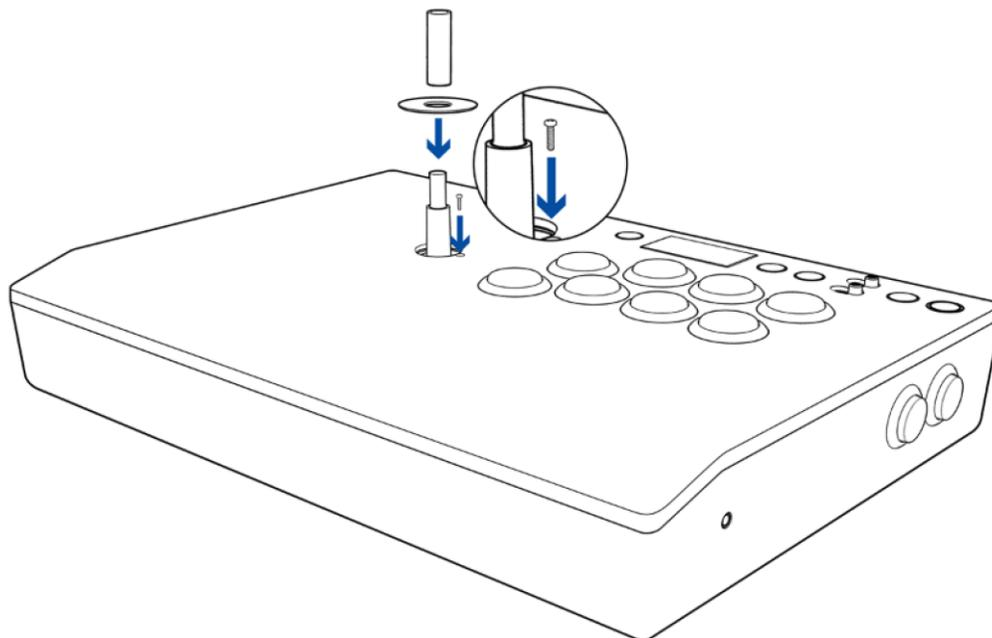
11. Tout en maintenant fermement le tournevis plat dans la vis à l'intérieur du trou d'accès, faites tourner la partie supérieure sphérique dans le sens des aiguilles d'une montre pour la fixer.
