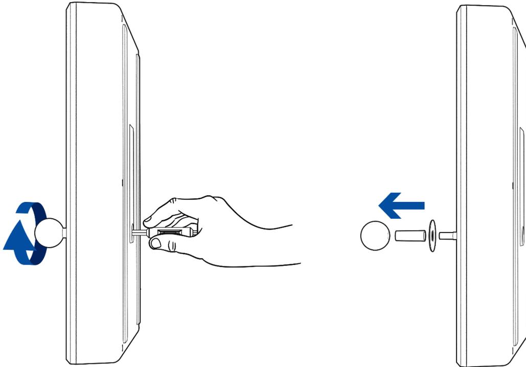
4. Placez le stick arcade sur une surface plate puis retirez la vis de la plaque de recouvrement.
