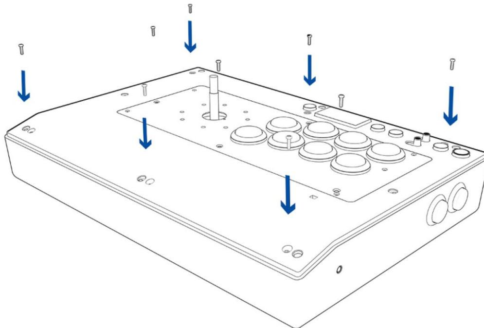
10. Placez l'illustration et la plaque de recouvrement sur le stick arcade, serrez la vis pour le fixer et retournez la gaine de la tige et la protection anti-poussière du joystick.
