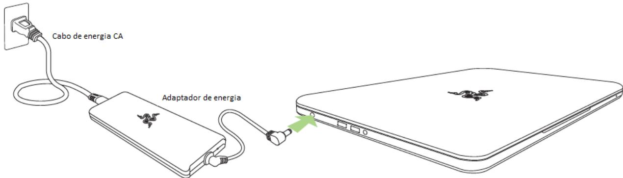
Certifique-se de que o plugue CA esteja devidamente inserido na tomada e no adaptador de energia. Um indicador se acenderá, mostrando que o adaptador está recebendo energia adequadamente. Insira o conector do adaptador de energia na porta de alimentação do Razer Blade.
