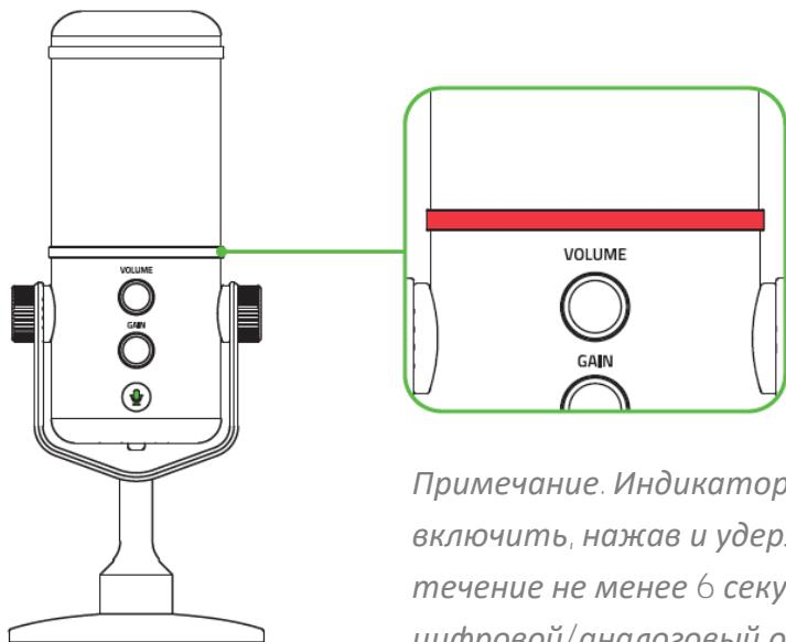
*Примечание. Индикатор перегрузки можно выключить или включить, нажав и удерживая кнопку выключения микрофона в течение не менее 6 секунд. Обратите внимание, что цифровой/аналоговый ограничитель продолжает работу даже при отключении индикатора перегрузки.*
