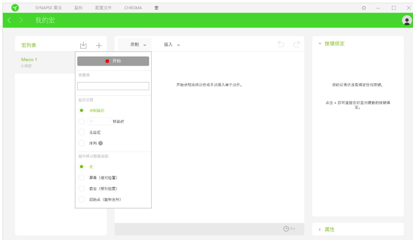
录制宏后，你可以通过在宏屏幕上选择每个命令来编辑你已输入的命令。每次击键或按键操作都会按顺序排列，且屏幕顶部显示的是以第一个命令排列的顺序。“插入”菜单允许你添加其他击键、按键操作、键入文本、运行命令、循环一组命令，或插入整个宏组。
