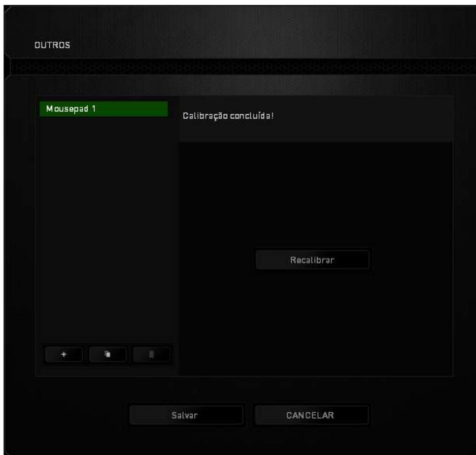
Para iniciar a calibragem do sensor, clique no botão. Depois de clicar no **Recalibrar** botão, o Razer Synapse começará a ajustar o sensor. Evite mover o Razer DeathAdder durante essa operação.
