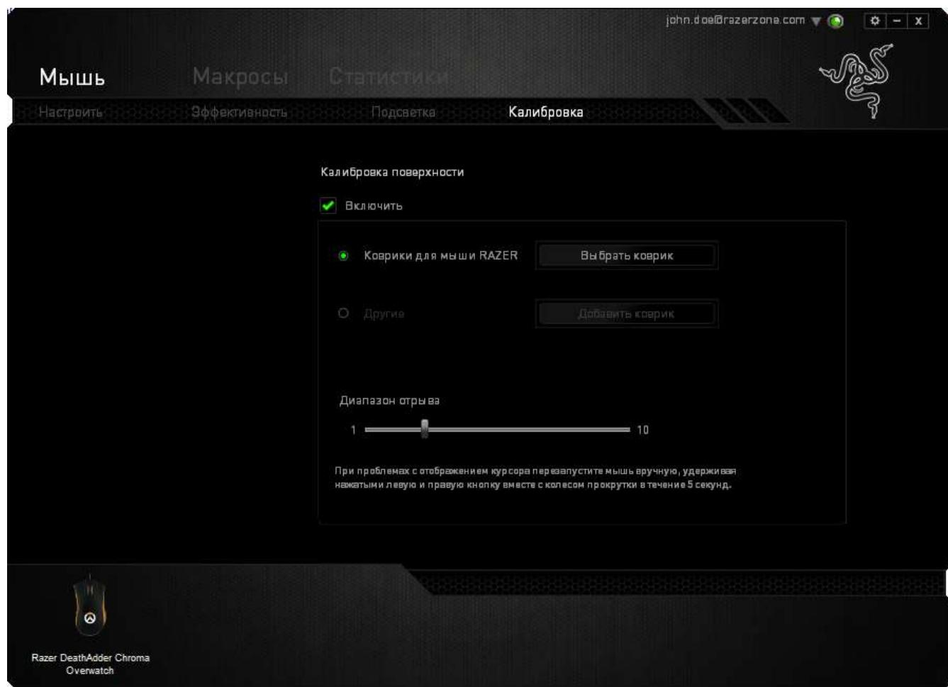
Параметр ДИАПАЗОН ОТРЫВА позволяет задать значение расстояния, при котором датчик перестает функционировать при отрыве мыши от рабочей поверхности. Чтобы использовать данную возможность, сначала необходимо активировать параметр КАЛИБРОВКА ПОВЕРХНОСТИ, а затем выбрать соответствующую рабочую поверхность. При активации параметра КАЛИБРОВКА ПОВЕРХНОСТИ необходимо выбрать тип рабочей поверхности, соответствующий используемому в данный момент типу поверхности.
