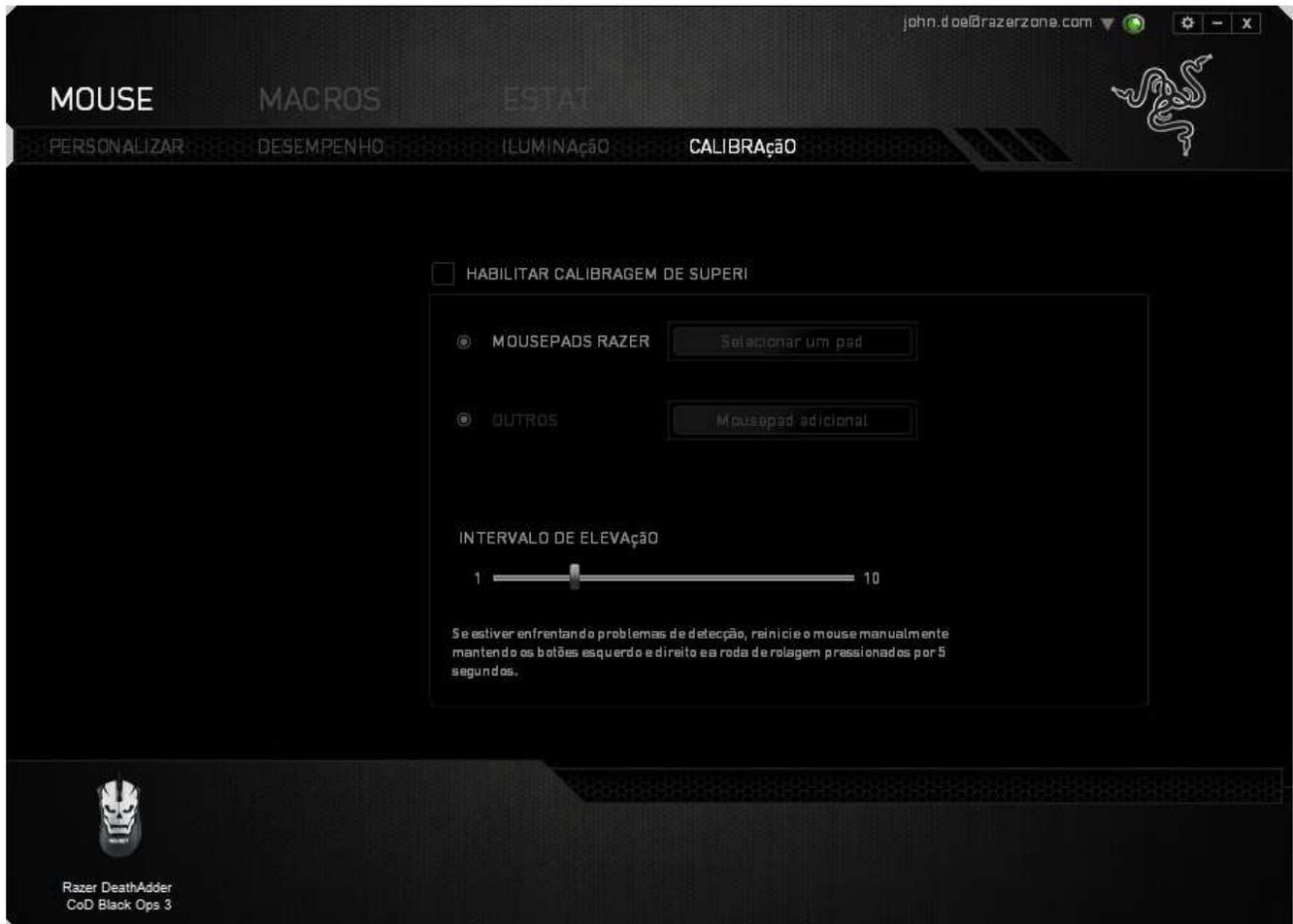
A *AMPLITUDE DE LEVANTAMENTO* permite que você defina a distância que o sensor deixa de se movimentar quando for levantado da superfície do mouse. Para utilizar este recurso, você deve, primeiro, ativar a *CALIBRAGEM DA SUPERFÍCIE* e, em seguida, escolher a superfície apropriada para o mouse.
