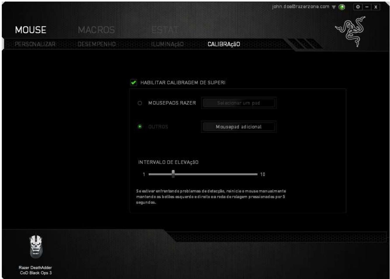
Neste submenu, você pode ajustar manualmente o Sensor de precisão Razer para que se adapte à sua superfície.
