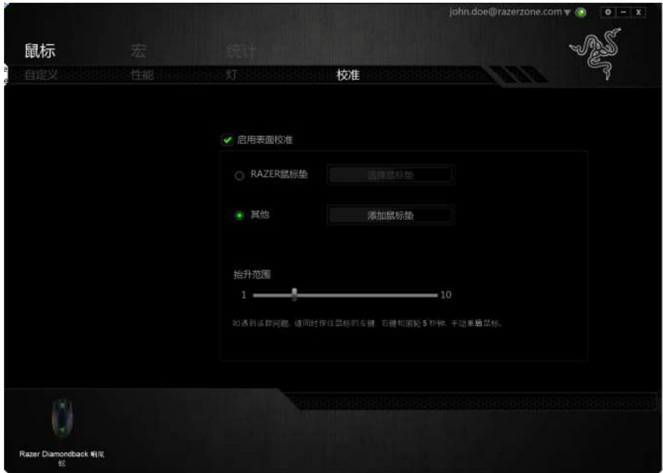
此子菜单允许您手动将 Razer Precision 传感器调整为适应任何鼠标移动表面。
