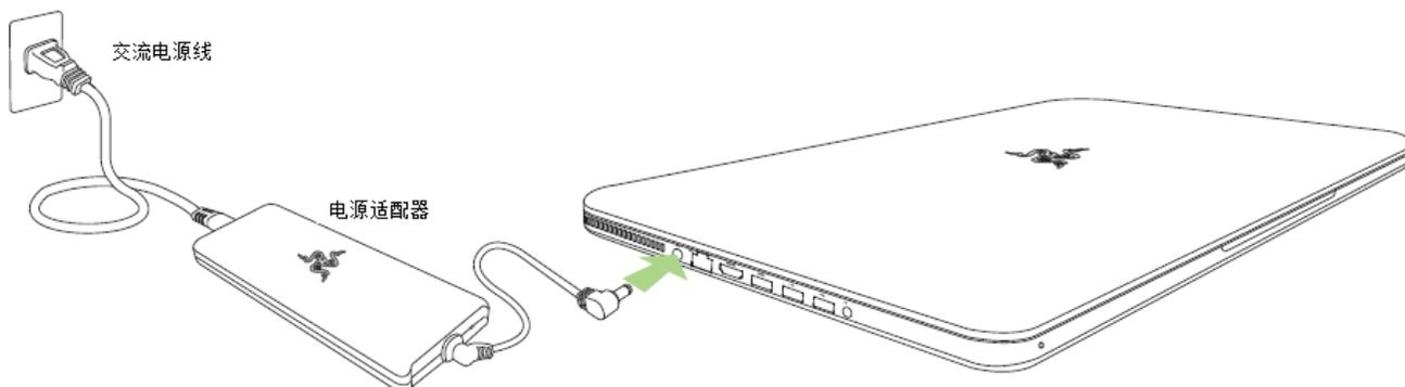
确保将交流电源线正确地插入插座和电源适配器。指示灯亮起表示适配器已接入了合适的电源。将电源适配器的接头插入Razer Blade Pro灵刃专业版笔记本电脑的电源端口。按下电源键开启Razer Blade Pro灵刃专业版笔记本电脑。
