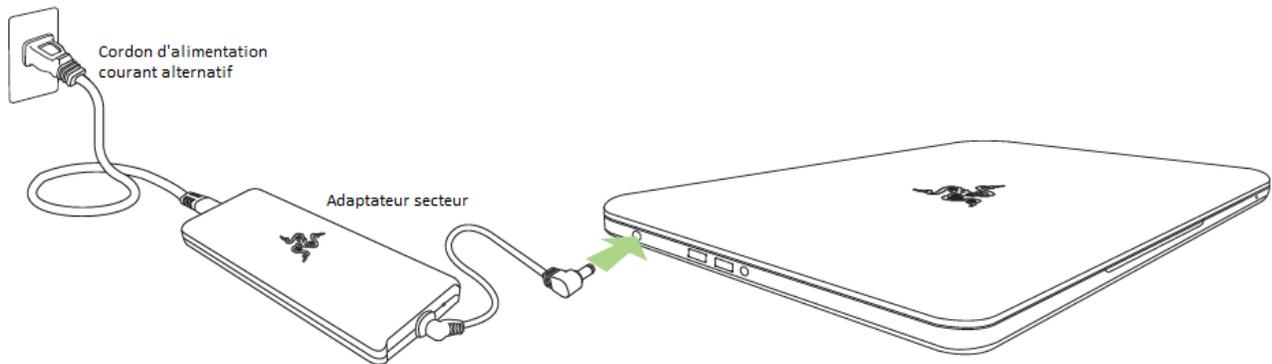
Assurez-vous que la prise courant alternative est correctement insérée dans la prise d'alimentation et l'adaptateur secteur. Un témoin lumineux s'éclaire lorsque l'adaptateur reçoit l'alimentation nécessaire. Insérez le connecteur de l'adaptateur secteur dans le port d'alimentation du Razer Blade. Appuyez sur le bouton marche/arrêt pour allumer votre Razer Blade.
