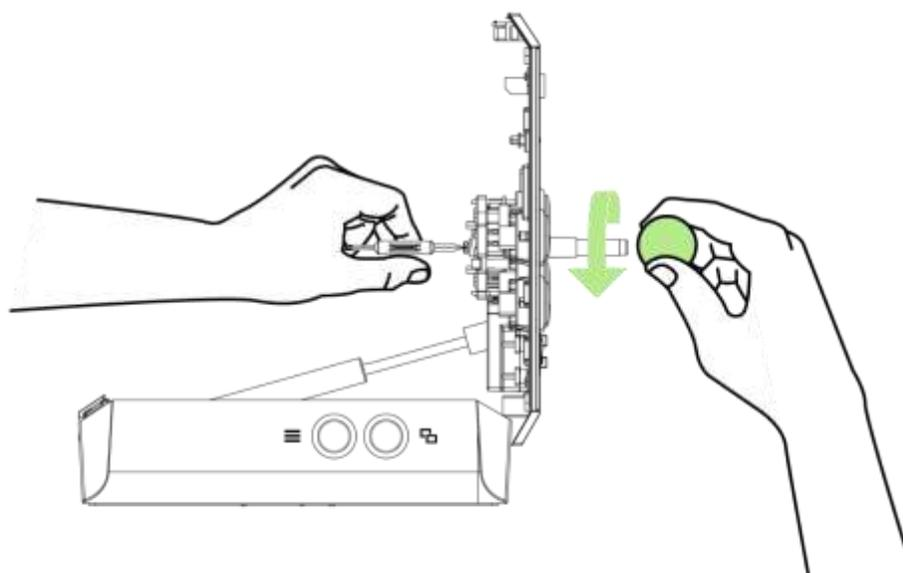
5. Retire a tampa do eixo e o limpador de sujeira do eixo de joystick.
