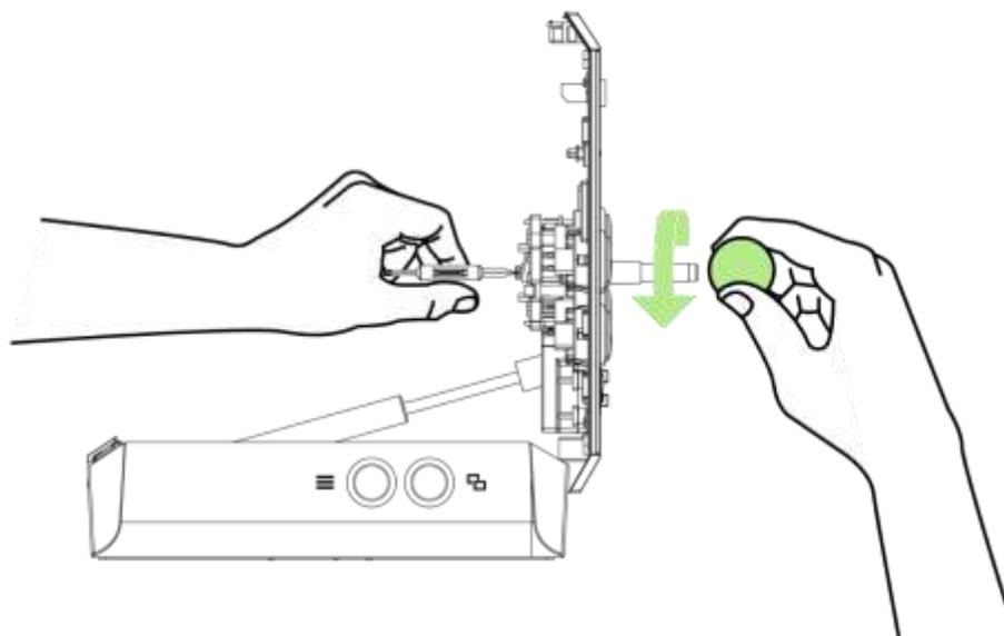
5. Retire a tampa do eixo do joystick.
