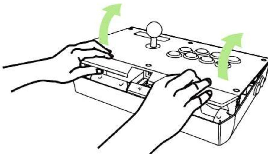
3. Retire o Cabo Removível com o Cabo Conector conectado.
