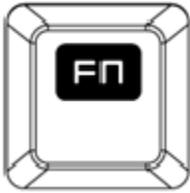
Beim Drücken der „FN“-Taste in Verbindung mit den Funktionstasten werden die sekundären Funktionen aktiviert.
