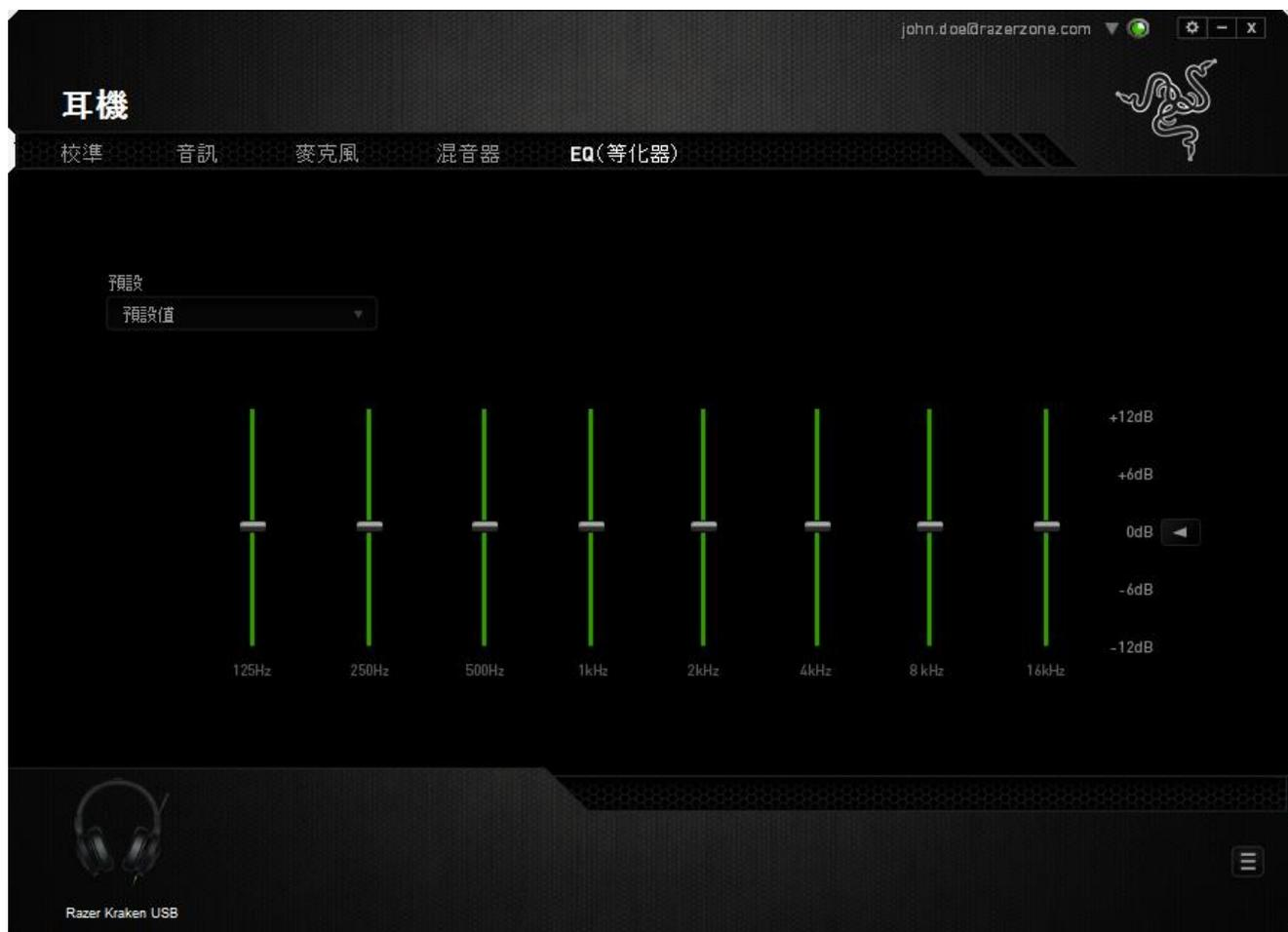
可透過下拉式選單挑選預設的音訊效果，讓您可以輕鬆換成常用的幾種音訊調性。您也可透過滑桿手動調整每個音訊頻率。
