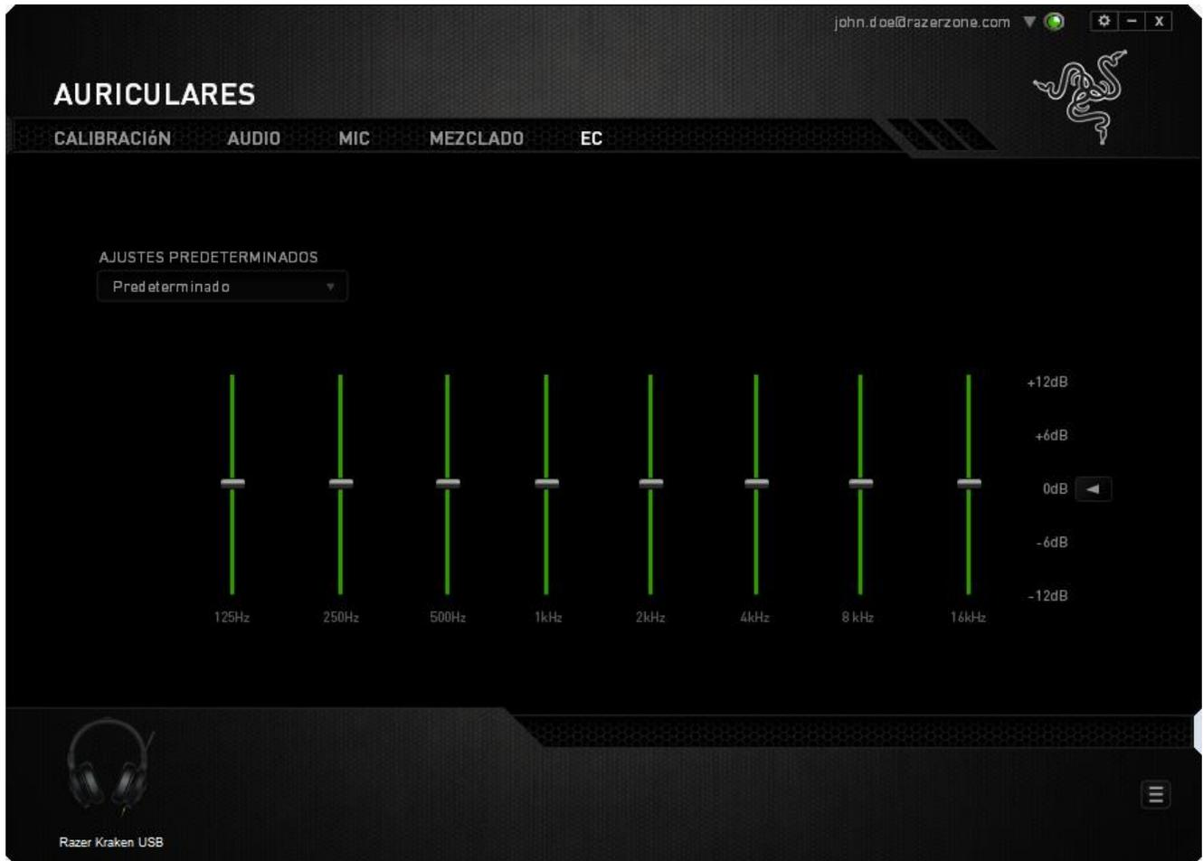
En el menú desplegable se puede seleccionar una lista de ajustes predefinidos del ecualizador. Esto da un acceso fácil a diversos tonos de audio usados habitualmente. También se puede ajustar manualmente cada frecuencia de audio mediante los controles deslizantes.
