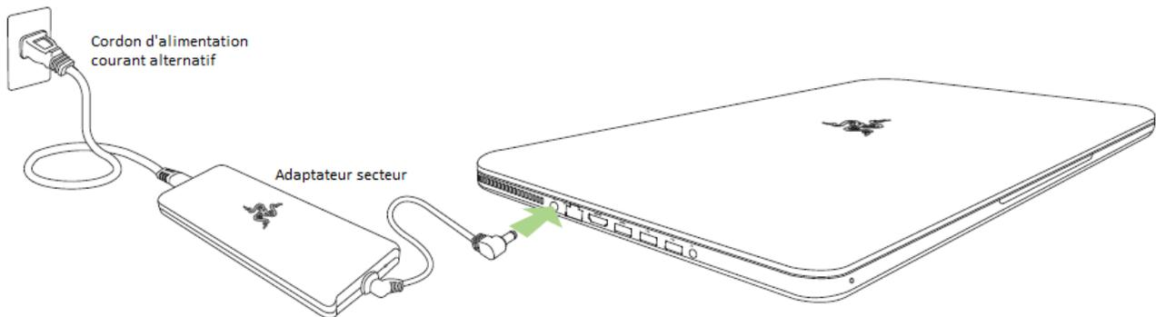
Assurez-vous que la prise à courant alternatif est correctement insérée dans la prise d'alimentation et l'adaptateur secteur. Un témoin lumineux s'éclaire lorsque l'adaptateur reçoit l'alimentation nécessaire. Insérez le connecteur de l'adaptateur secteur dans le port d'alimentation du Razer Blade Pro. Appuyez sur le bouton marche/arrêt pour allumer votre Razer Blade Pro.
