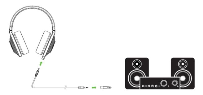
Примечание. Если гарнитура подключена к устройству с разъемом на ¼" (6,35 мм), встроенный микрофон не работает.
