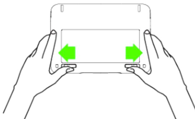
2. Удалите крышку отсека батарей.
