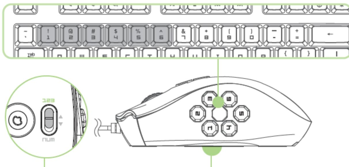
En mode basique [123], la pouce à 6 boutons mécaniques fonctionne comme les touches numériques d'un clavier : elle reproduit la barre d'actions de la plupart des jeux.
