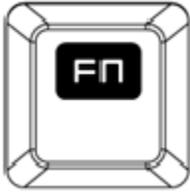
Pulsa la tecla "FN" junto con las teclas de función para activar las funciones secundarias.
