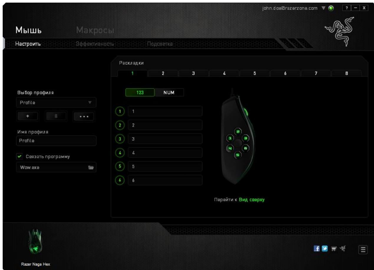
Можно настроить оба режима (основной [123] и дополнительный [Num]) с помощью переключателя в середине экрана. Настройка механических кнопок для большого пальца в любом режиме не требует использования переключателя, расположенного на нижней части корпуса мыши Razer Naga Hex. Однако этот переключатель необходим для переключения между основной [123] и дополнительной [Num] конфигурацией.
