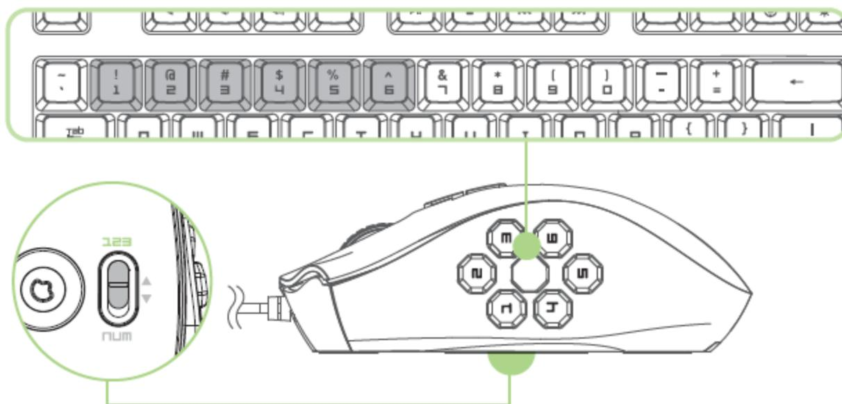
В основном [123] режиме 6 механических кнопок для большого пальца работают так же, как клавиши цифр на основном блоке клавиатуры. Эти кнопки позволяют дублировать на панели для большого пальца функции панели действий большинства игр.
