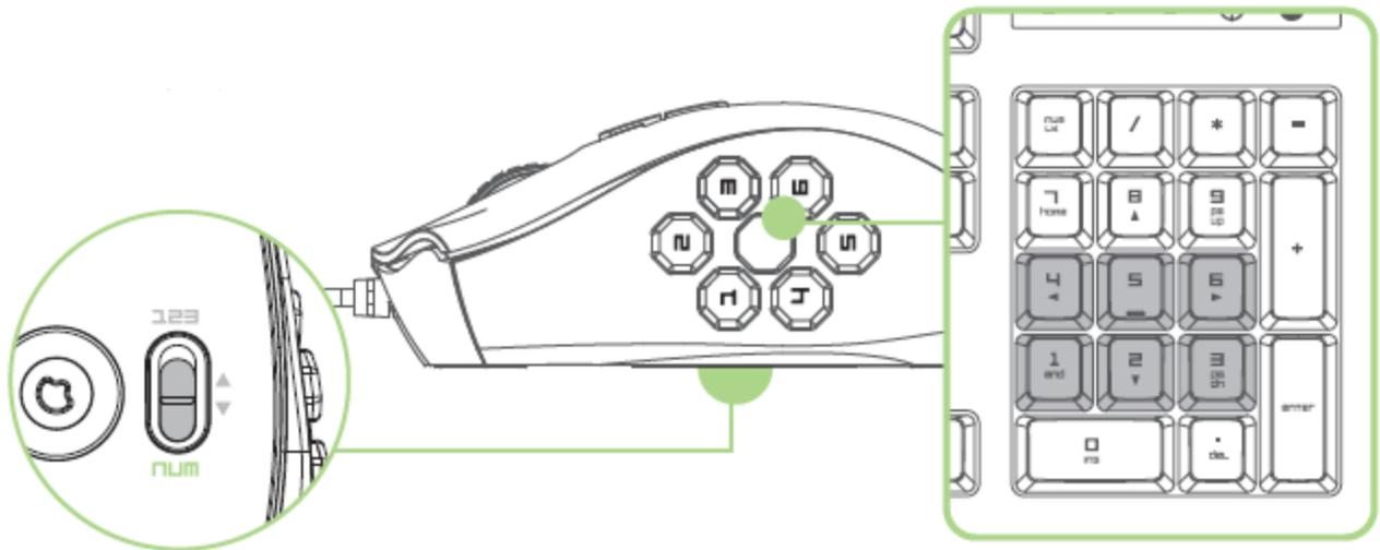
В дополнительном [Num] режиме-нумерации, 6 механических кнопок для большого пальца работают так же, как клавиши цифрового блока (Num Pad) клавиатуры. Эти кнопки обеспечивают более быстрый доступ к игровым командам без использования цифровой панели.
