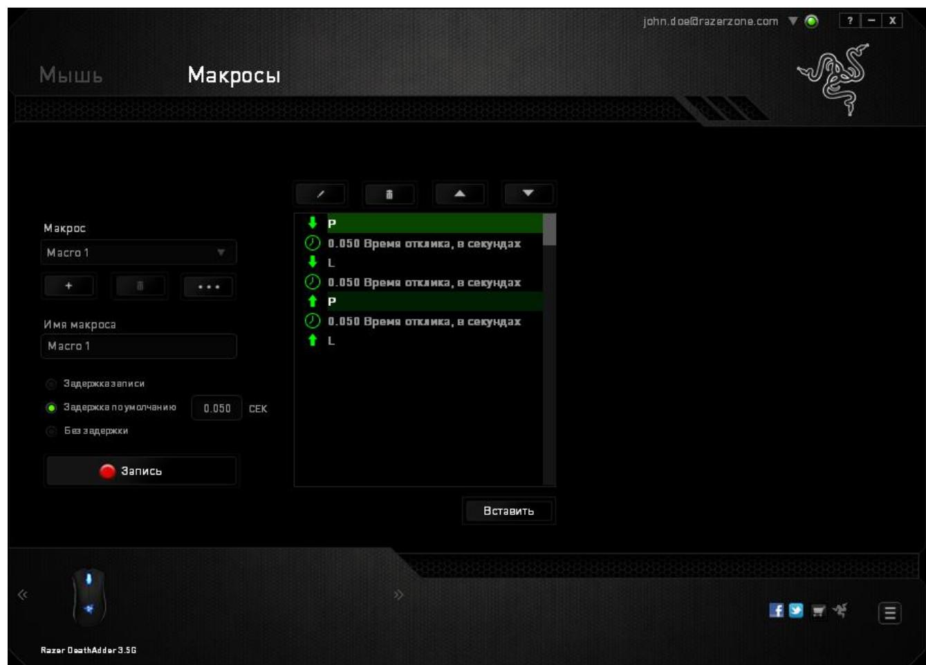
Кнопка позволяет редактировать определенную команду, а кнопка используется для удаления команд. Кнопки и используются для перемещения команд вверх и вниз. Кнопка используется для вставки дополнительных нажатий клавиш и кнопок и временных задержек до или после выбранной команды.
