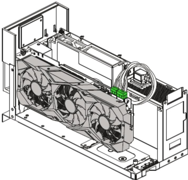
6. 将主机舱滑回机箱中，然后推动手柄将其锁定。
