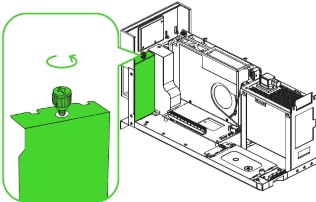
3. 将支持的显卡插入 PCI-E 插槽。
